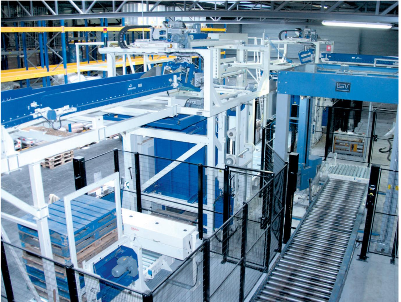
Palettiermaschine mit dezentral geregelten Asynchronantriebssystemen
