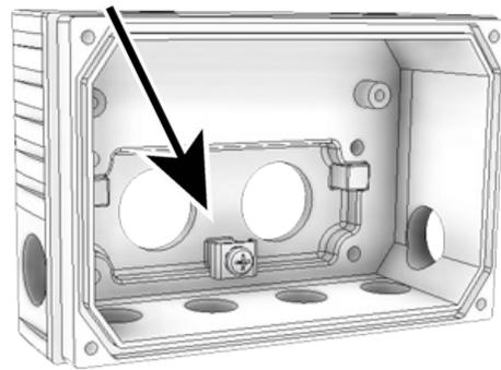
Connection unit of optional module SK TI4-TU-...
