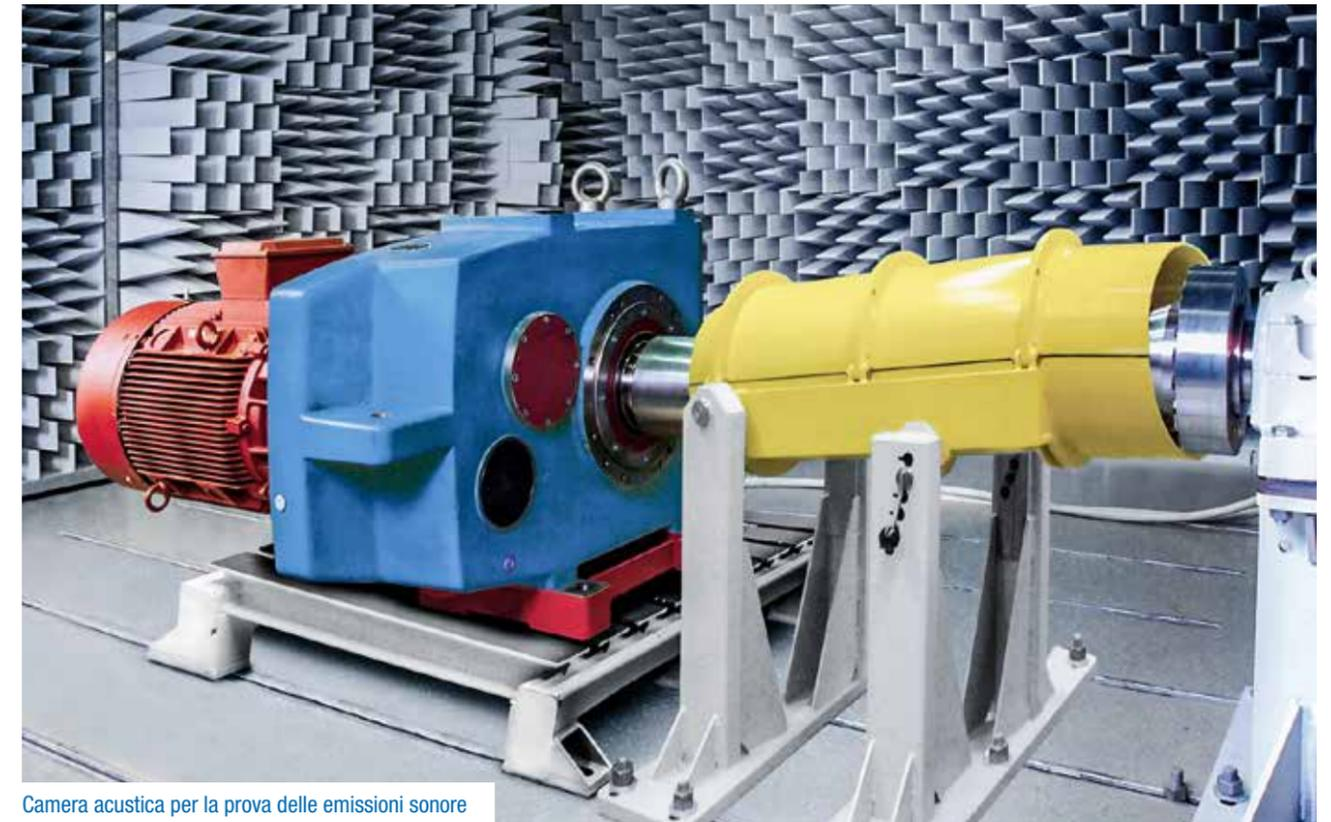
Camera acustica per la prova delle emissioni sonore
