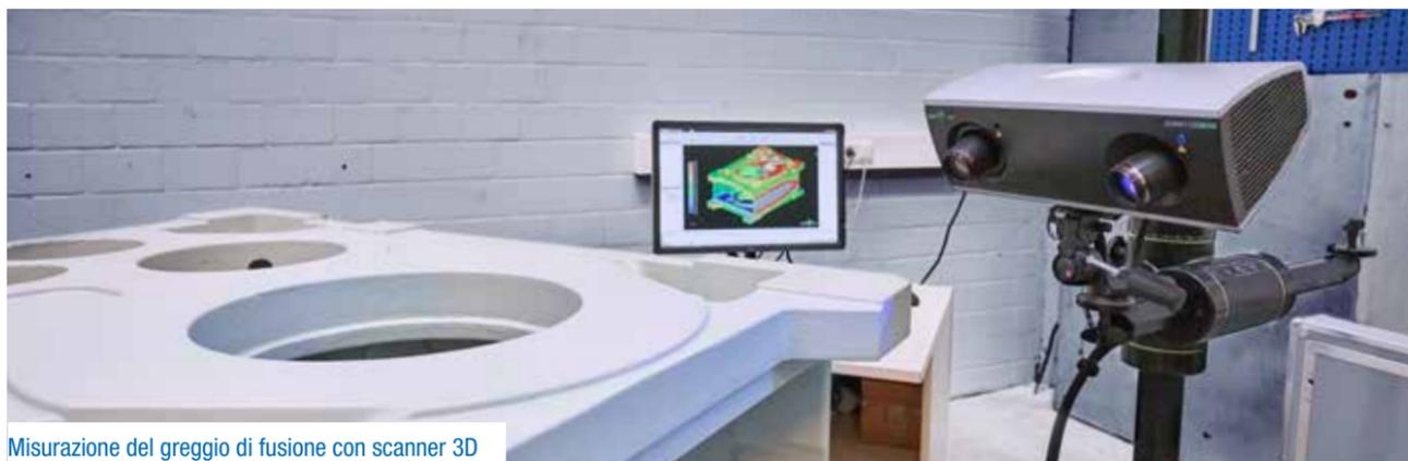
Misurazione del greggio di fusione con scanner 3D
