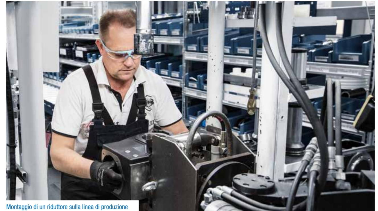
Montaggio di un riduttore sulla linea di produzione
