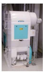
Reinigungskraft. Per NORD-Antrieb werden Leichtprodukte aus einem Umluftabscheider ausgetragen.
