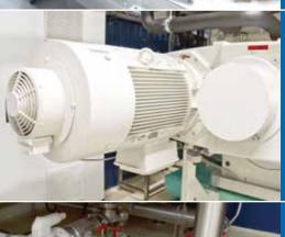
NORD-Flachgetriebemotor treibt die Conche an.
