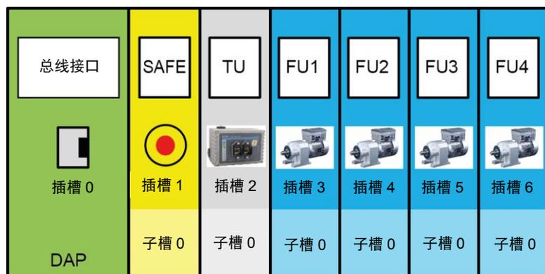
图 11: 示例——用于分布式设备的 PROFINET IP 设备模型
