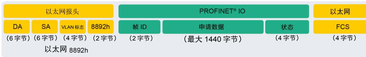
图 6: PROFINET IO 报文 (子网内通信)
