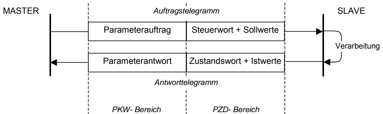
Bild: Telegrammverkehr / Aufbau Nutzdatenbereich
