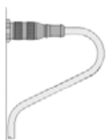
fest verlegte Leitung
