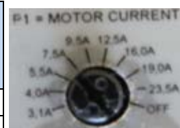
Figure : P1 d'un démarreur de 7,5 kW
