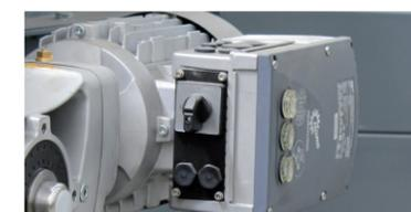
Interruttori e pulsanti si trovano sugli azionamenti e permettono di impartire direttamente i comandi di avvio e di arresto e di cambiare modalità.
