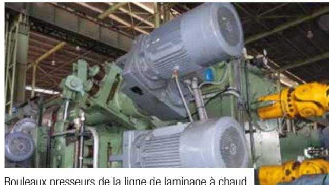
Rouleaux presseurs de la ligne de laminage à chaud
