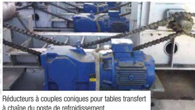
Réducteurs à couples coniques pour tables transfert à chaîne du poste de refroidissement
